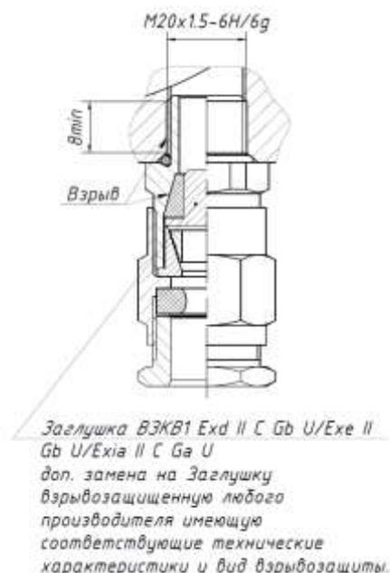
Рисунок 186 – Способ установки взрывозащищенной пробки в кабельный ввод
