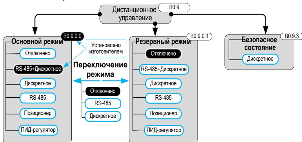
Рисунок 19 – Настройка режима работы по ДУ
