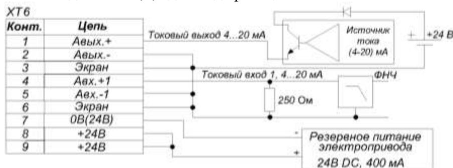
Рисунок 12и – Схема резервного питания электропривода для модификаций «17», «18», «19», «45»
