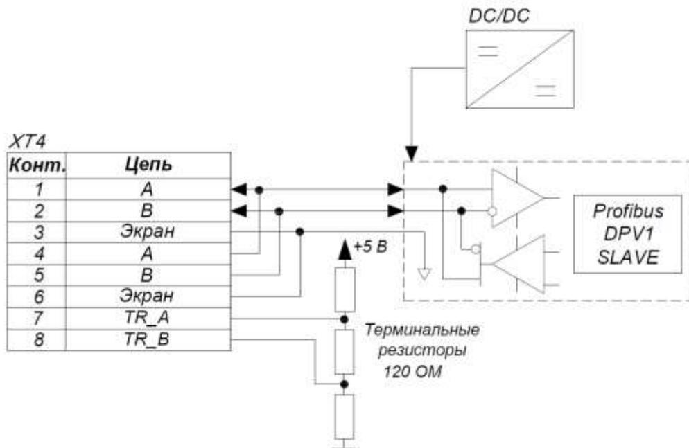
Рисунок 12ж – Структурная схема интерфейса Profibus DP
