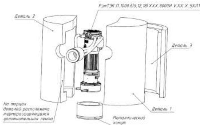
Рисунок 18в – Монтаж термочехла
