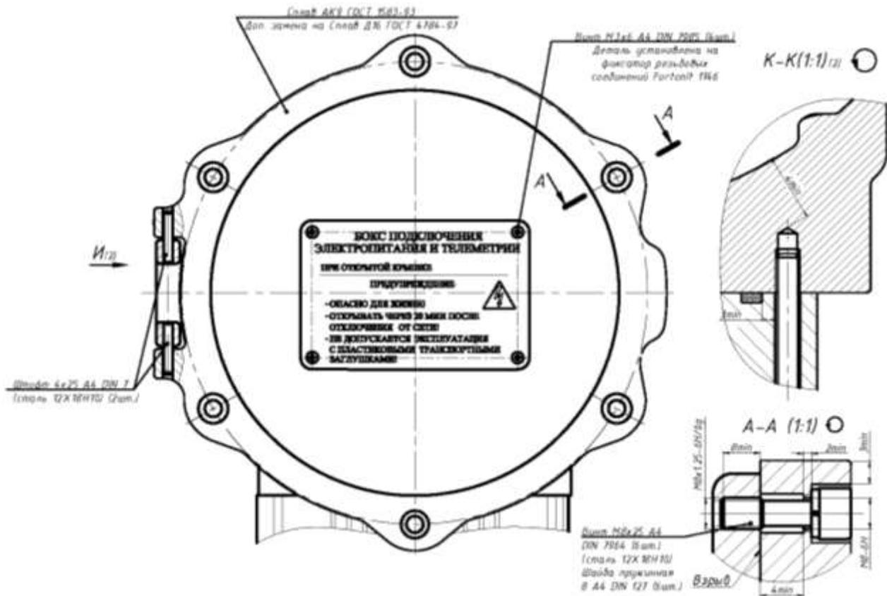
1. На поверхности, обозначенные надписью "Взрыв", не допускается наличие лакокрасочных покрытий и механических дефектов.
