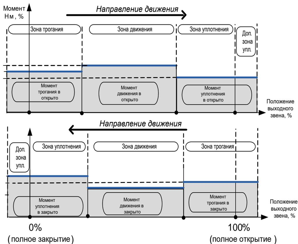
Рисунок 20 – Диаграмма движения запирающего элемента арматуры
