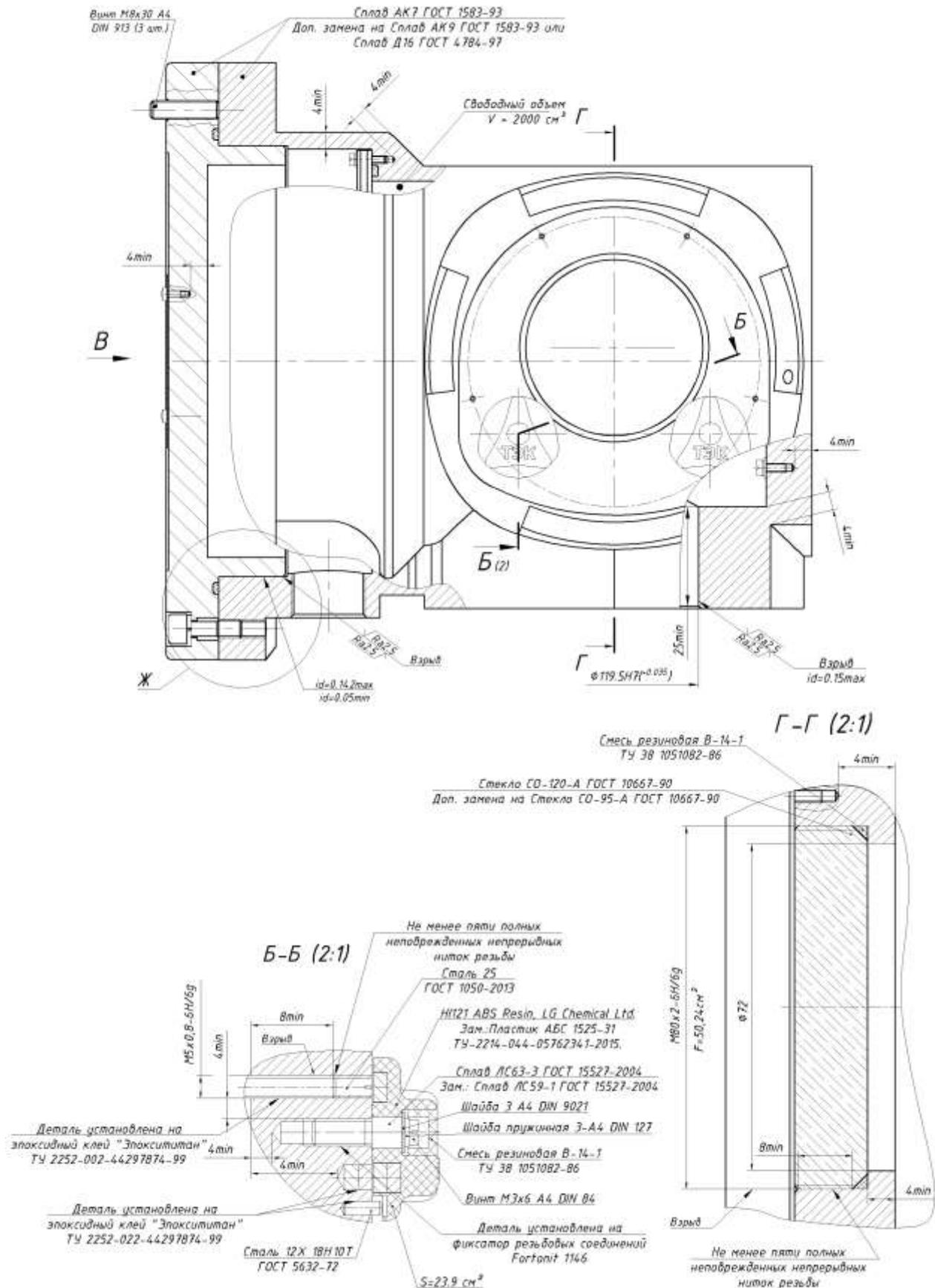
Рисунок Ж.6 – Чертеж средств взрывозащиты РэмТЭК конструктивного исполнения "82хх"
