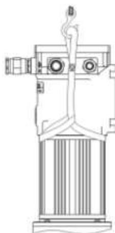
Рисунок 13 – Рекомендуемая схема строповки РэмТЭК без рым-болтов
