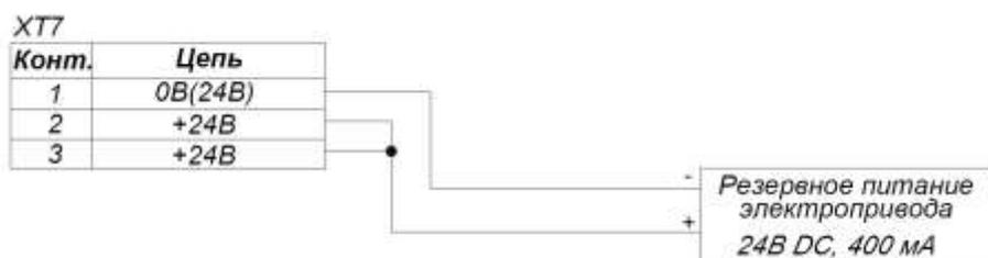
Рисунок 12к – Схема резервного питания электропривода для модификации «48»
