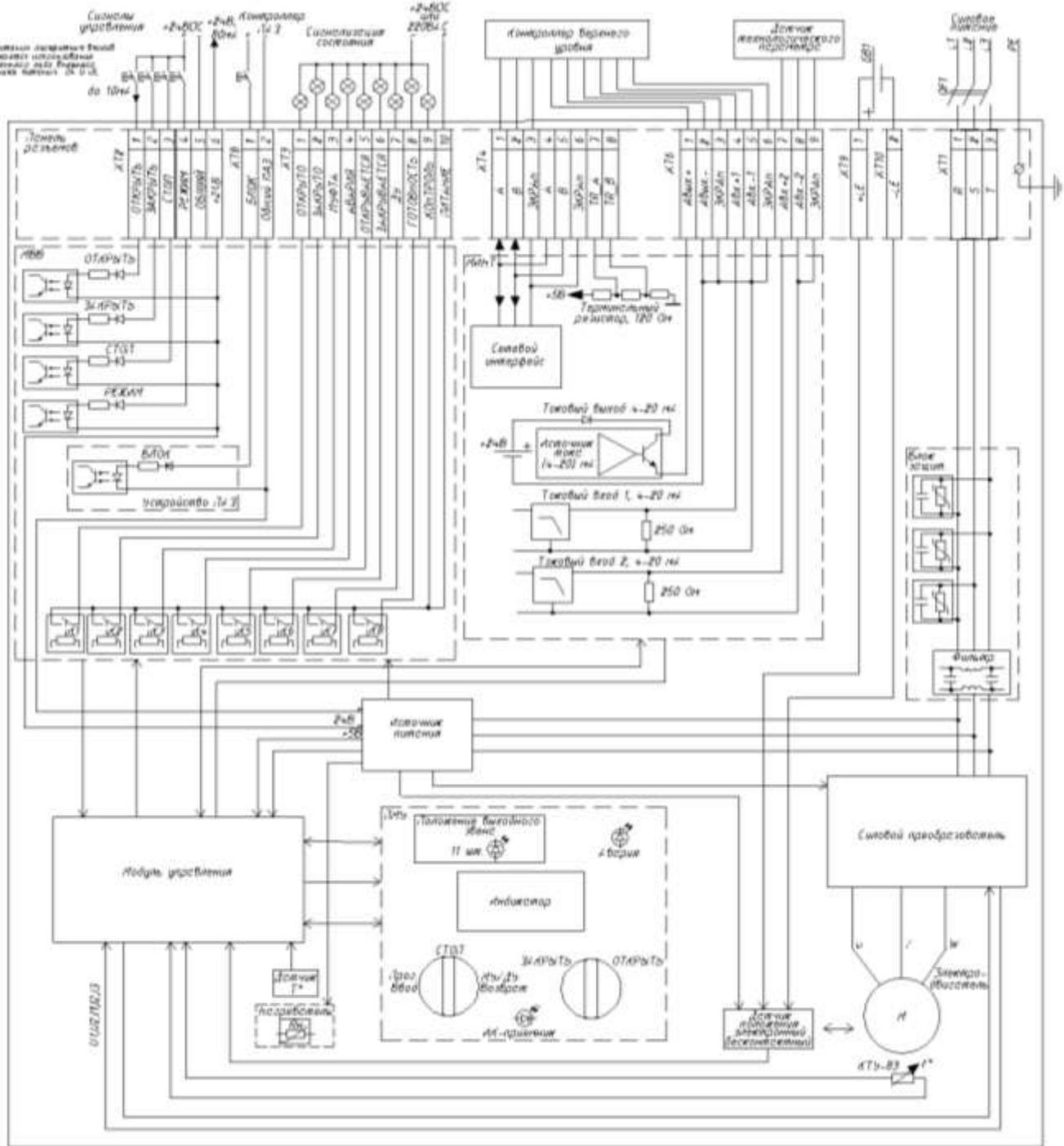
Рисунок И.2 – Схема электрическая функциональная РэмТЭК при питании от трехфазной цепи переменного тока напряжением 400 В или комбинированном питании напряжением 230/400 В частотой 50 Гц
