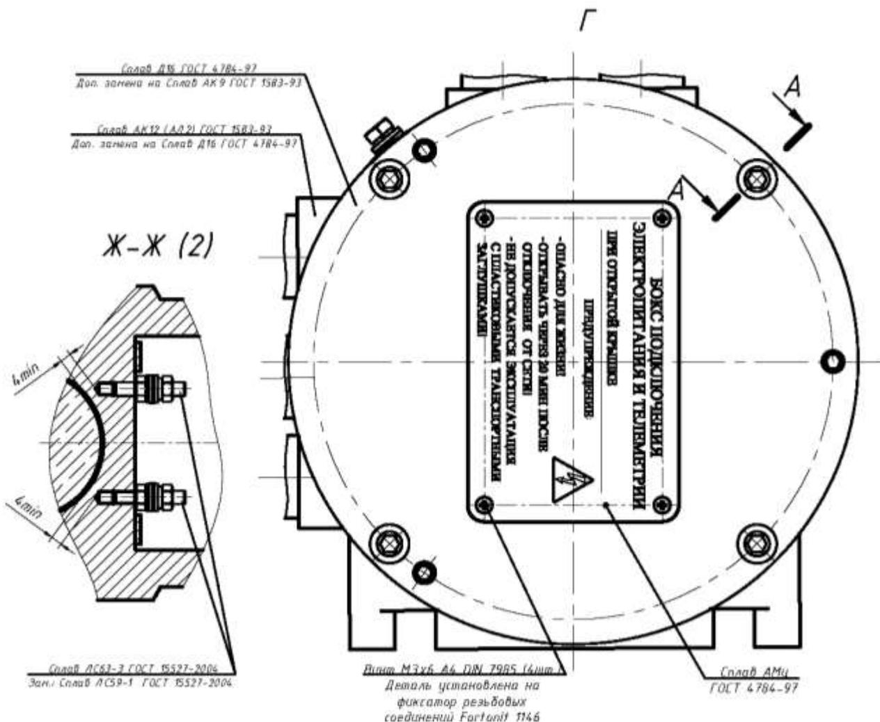
1. На поверхностях, обозначенных надписью "Взрыв", не допускается наличие лакокрасочных покрытий и механических дефектов.
