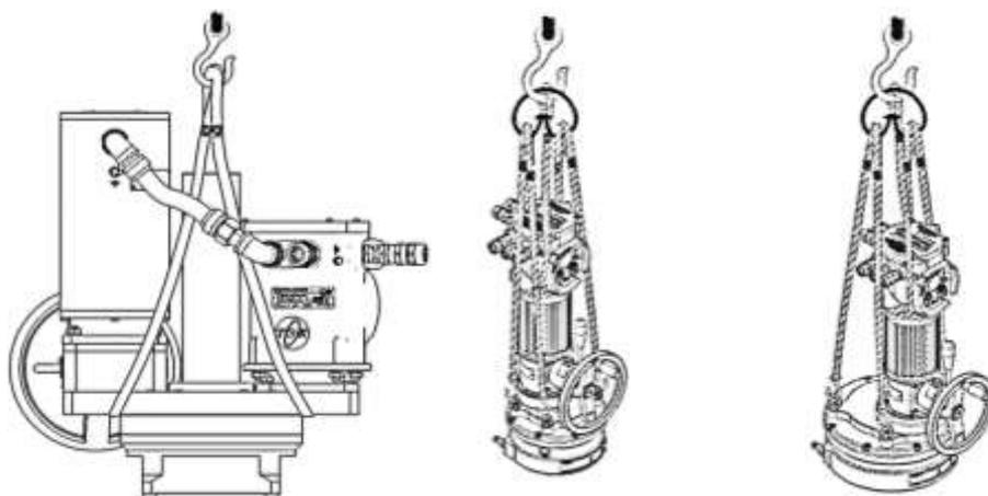
Рисунок 13а – Рекомендуемые схемы строповки РэмТЭК с рым-болтами
