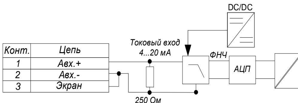
Рисунок 10а – Структурная схема аналогового входа
