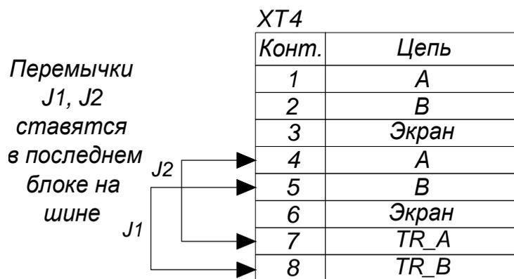
Рисунок 12г – Структурная схема подключения с помощью перемычек
