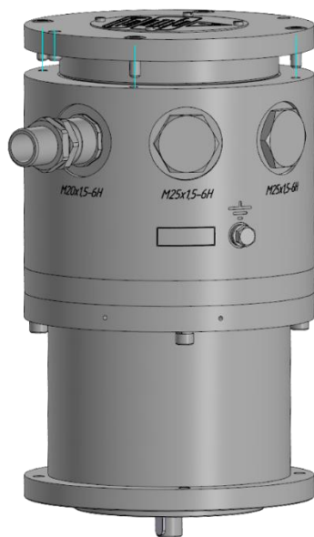
Рисунок 7 – Расположение болтов крепления крышки
