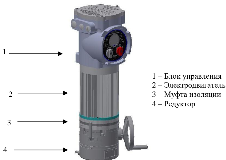
Рисунок 2 – Составные части электропривода РэмТЭК конструктивного исполнения «8»
