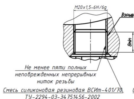
Рисунок Д.1 – Типы кабельных вводов, используемых в РЭМТЭК
