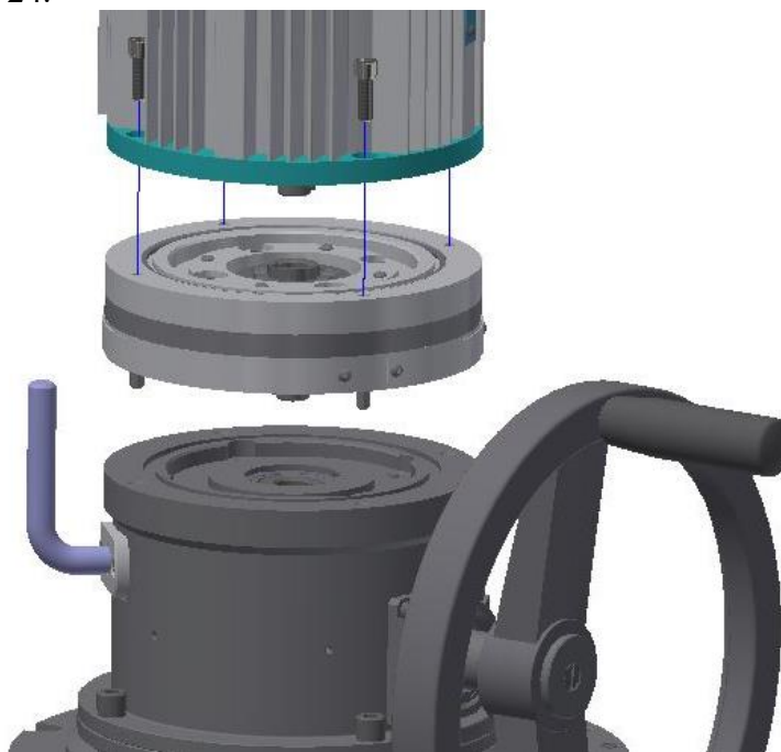
Рисунок 24 – Расположение муфты Ми-ЭД
