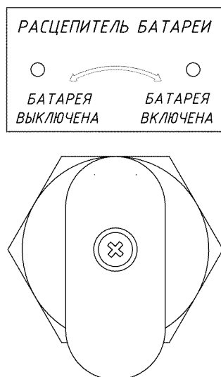
Рисунок 7 – Внешний вид механического расцепителя
