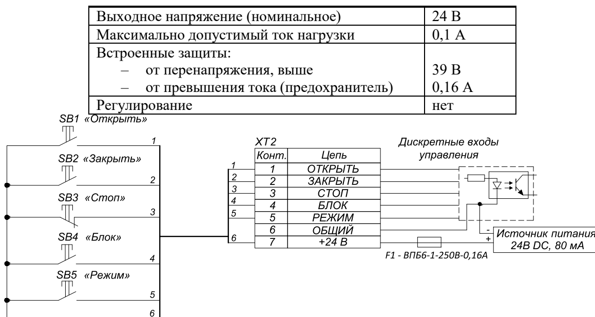
Рисунок 8 – Пример подключения с использованием встроенного источника питания дискретных входов
