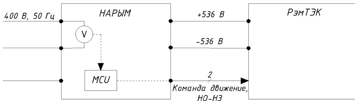
Рисунок 3 - Схема подключения с формированием сигнала команды энергонакопителем
