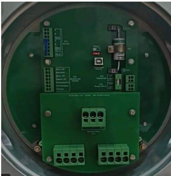
Рисунок 5 - Внешний вид бокса подключения энергонакопителя
