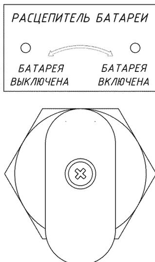
Рисунок 7 – Внешний вид механического расцепителя
