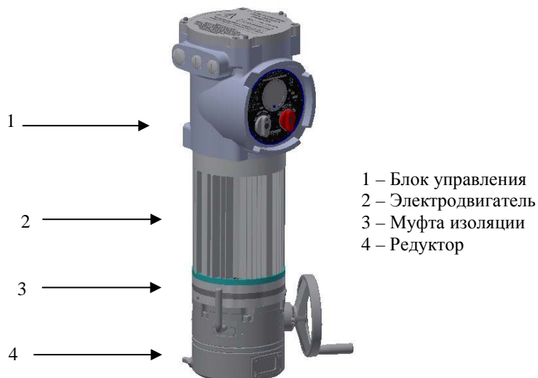
Рисунок 2 – Составные части электропривода РэмТЭК конструктивного исполнения «8»
