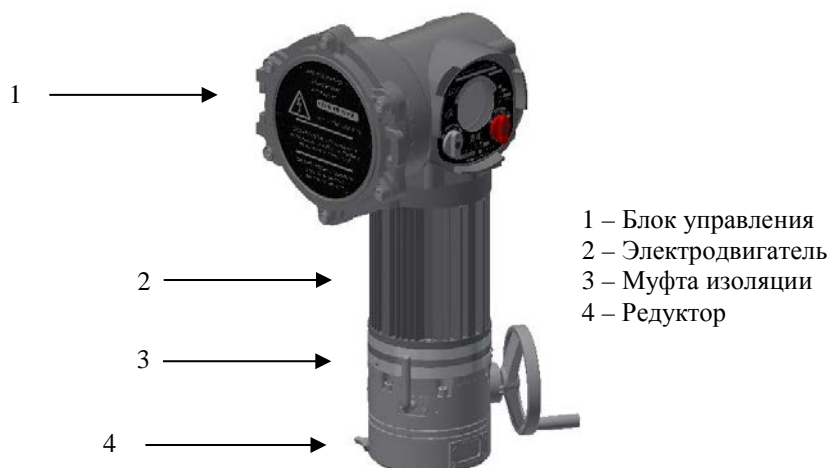
Рисунок 3 – Составные части электропривода РэмТЭК конструктивного исполнения «81»
