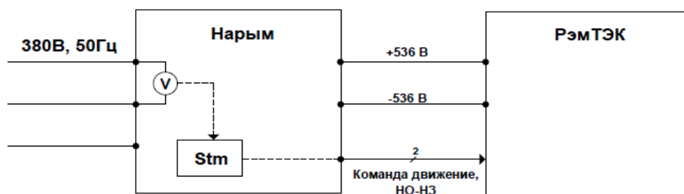
Рисунок 3 - Схема подключения с формированием сигнала команды энергонакопителем
